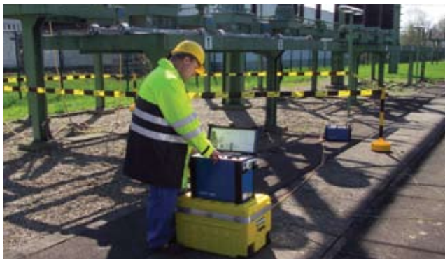
Medición con CPC 100 y CP CU1
