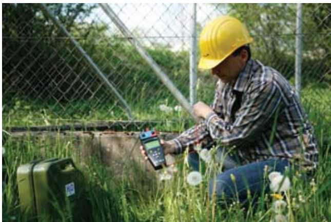
Medición de Tensión de Contacto con el CP AL1, CPC 100 y el CP CU1
